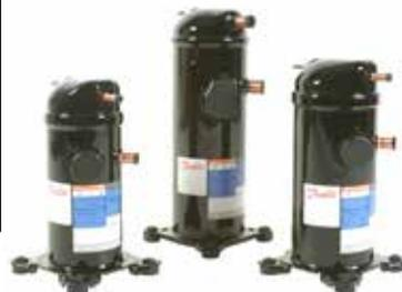
Модельный ряд спиральных компрессоров MLZ специально разработан для холодильного применения. Компрессор предназначен для работы с хладагентами R22, R404A, R134a, R507. Свою максимальную эффективность компрессор показывает при работе на R404A в режиме  $-10^{\circ}\text{C}/40^{\circ}\text{C}$ .
