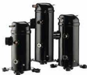
Спиральные компрессоры нового поколения Danfoss LLZ, изготовленные с помощью передовых технологий, имеют уникальную конструкцию, отличаются высокой эффективностью и могут использоваться в холодильных установках различного назначения. Компрессор предназначен для работы с хладагентами R404A, R507.
