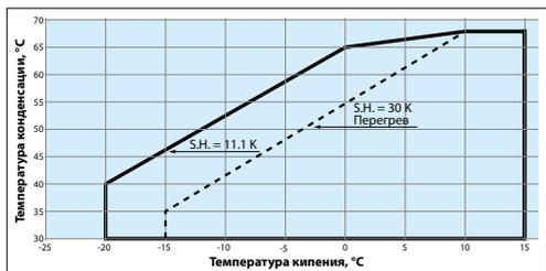
Область эксплуатации компрессоров SZ 240-380 и SY 240-300 с хладагентом R407C при температуре точки росы
